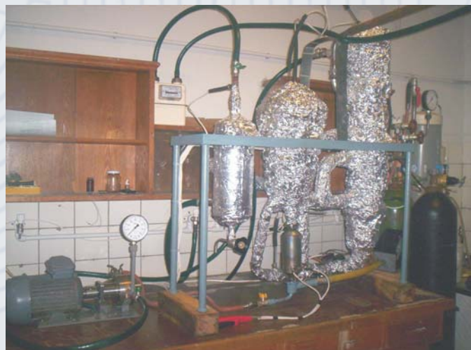
Пилотная установка получения синтез-газа конверсией ПГ под давлением 1,0 МПа
