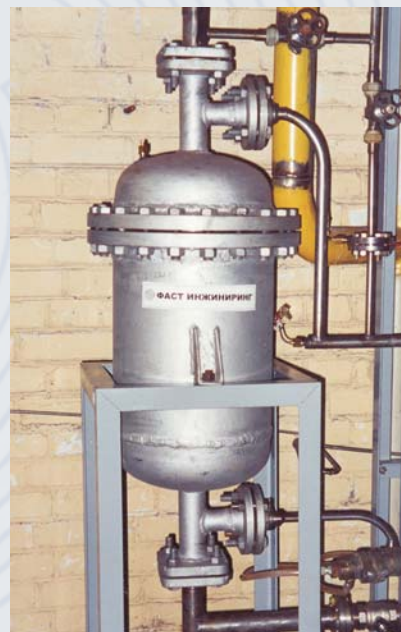
Изотермический реактор паровой конверсии CO
