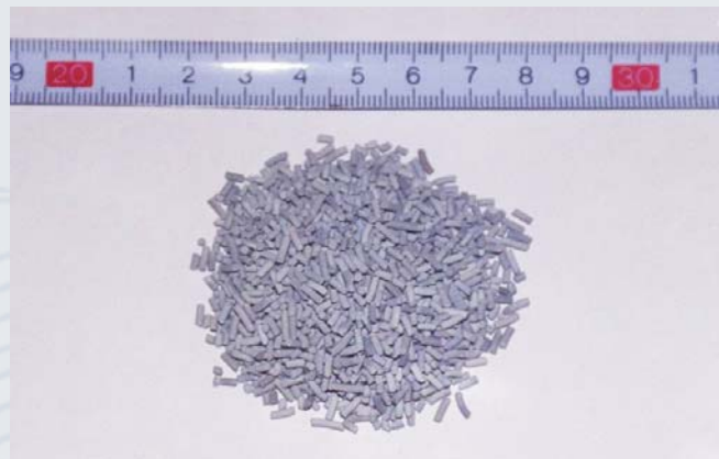
Катализатор конверсии природного газа КФИ-10
